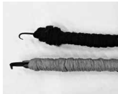
沖縄の沈金刀 (上:丸刀、下:ぜんまい刀) 沖縄県工芸振興センターHPより転載
