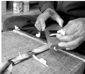
漆刷毛の木材を鉋で削って剥がし、人毛だけの状態にする様子（越前漆器）
