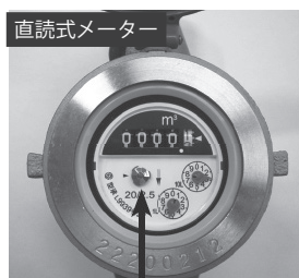
直読式メーター パイロットマークが回る。
