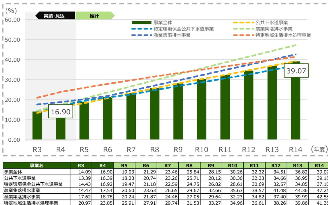
図 3-15 下水道施設の老朽化の推移
